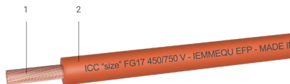
1. Rame rosso flessibile classe 5 EN 60228 | Flexible copper Class 5 EN 60228 2. Gomma G17 LSOH | Rubber G17 LSOH
