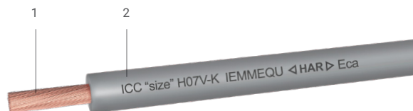
1. Rame flessibile classe 5 CEI EN 60228 | Flexible copper Class 5 CEI EN 60228 2. PVC T11 | PVC T11
