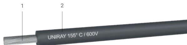
1. Rame flessibile Classe 5 EN 60228 | Flexible copper Class 5 CEI EN 60228 2. Tecnopolimero irraggiato antinfiamma | Flame retardant irradiated technopolymer
