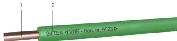
1. Rame rigido Classe 1 CEI EN 60228 | Solid copper Class 1 CEI EN 60228 2. Gomma siliconica EI2 | Silicone rubber EI2
