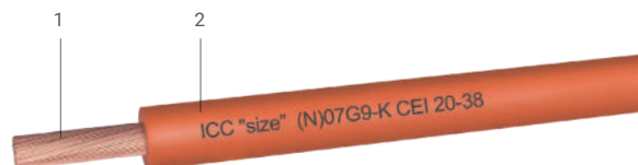
1. Rame flessibile classe 5 CEI EN 60228 | Flexible copper Class 5 CEI EN 60228 2. Gomma G9 LSOH | Rubber G9 LSOH
