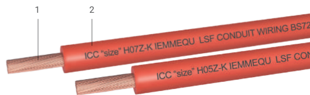
1. Rame flessibile Classe 5 CEI EN 60228 | Flexible copper Class 5 CEI EN 60228 2. Gomma EI5 LSOH | Rubber EI5 LSOH
