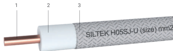
1. Rame rigido Classe 1 CEI EN 60228 | Solid copper Class 1 CEI EN 60228 3. Treccia in fibra di vetro | Fiberglass braid
