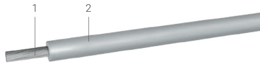
1 – Rame flessibile classe 5 / Flexible copper class 5 CEI EN 60228 2 – Tecnopolimero irraggiato antifiama Flame retardant irradiated technopolymer
